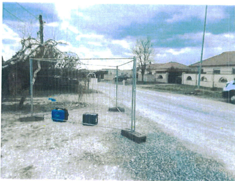
10. számú fényképfelvétel Síp u. 16. szám előtti közútszakasz – szervetlen szálló rost (azbesztrost) koncentráció mintavétel Környezeti levegő mérés
