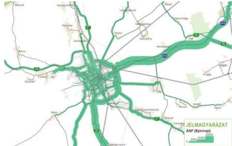
45. ábra Átlagos napi forgalmak a Szombathely környéki közúthálózaton (forrás: TRENECON Kft. Forgalmi modell)
