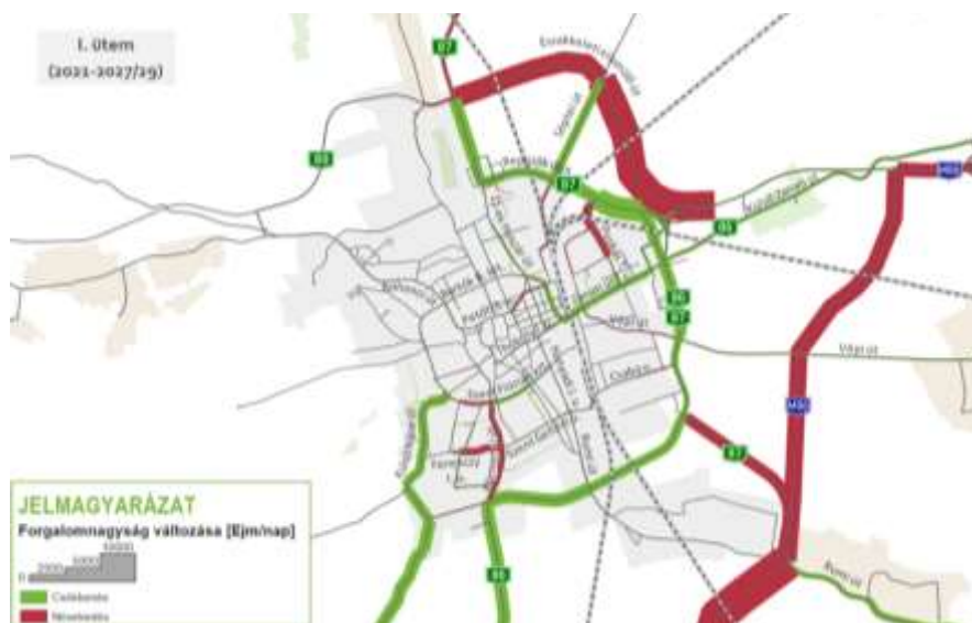
76. ábra Várható forgalom különbözet I. ütemben a közúti projektfejlesztés nélküli állapothoz képest (forrás: TRENECON Kft. Forgalmi modell)
