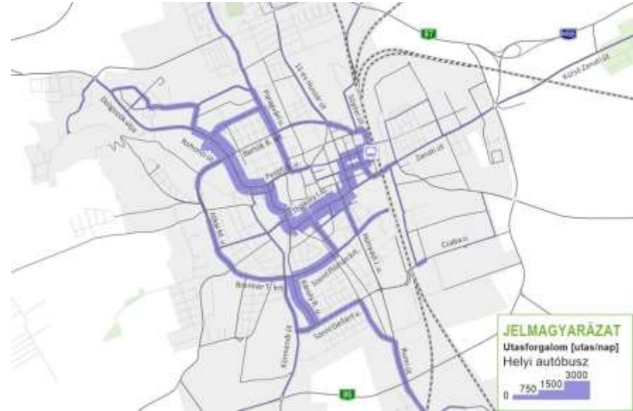
40. ábra Helyi közösségi közlekedés átlagos munkanapi utazásszáma (TRENECON Kft. forgalmi modell)
