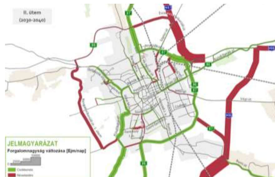
77. ábra Várható forgalom különbözet II. ütemben a közúti projektfejlesztés nélküli állapothoz képest (forrás: TRENECON Kft. Forgalmi modell)
