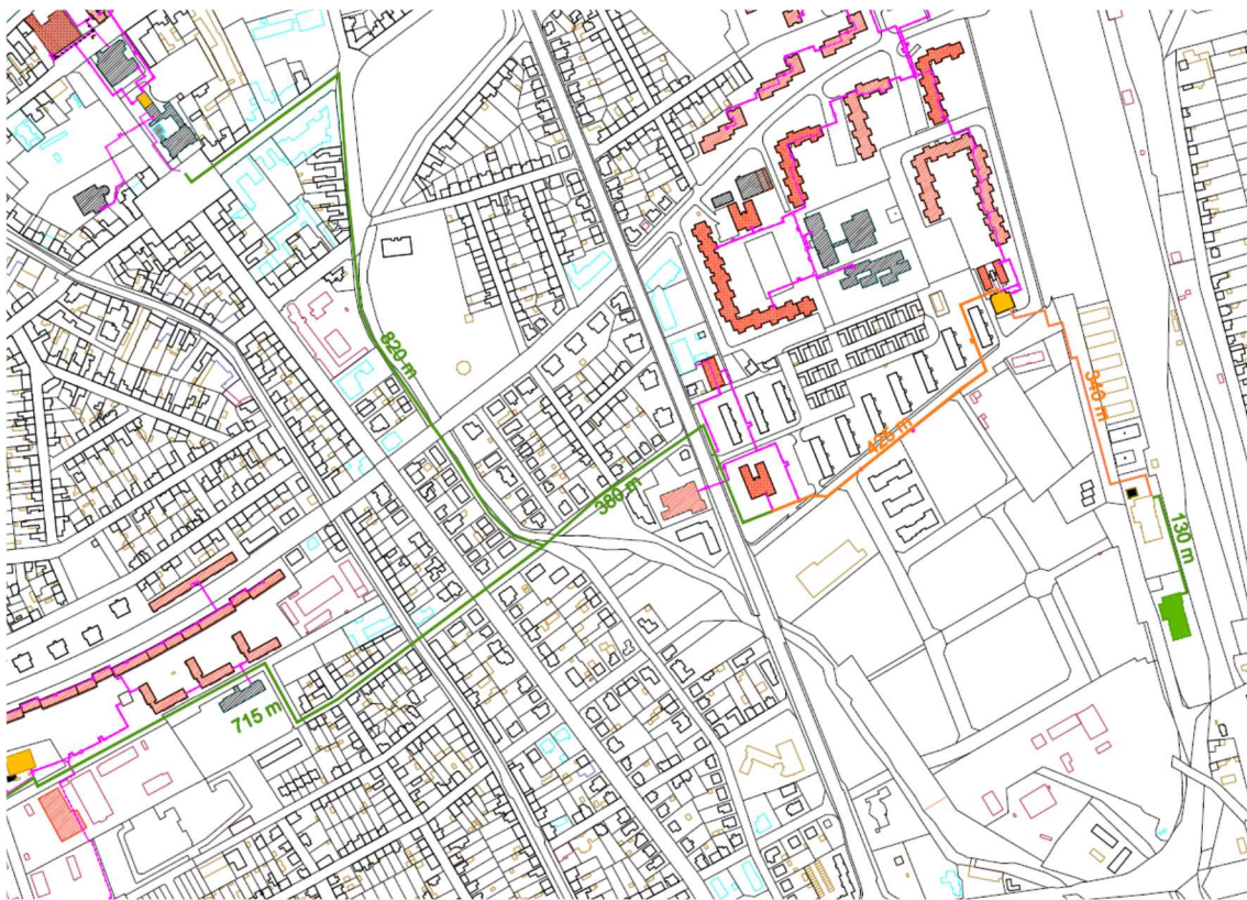
3.3.2.ábra A déli távhőkörzet, 3. változat szerinti nyomvonalak
