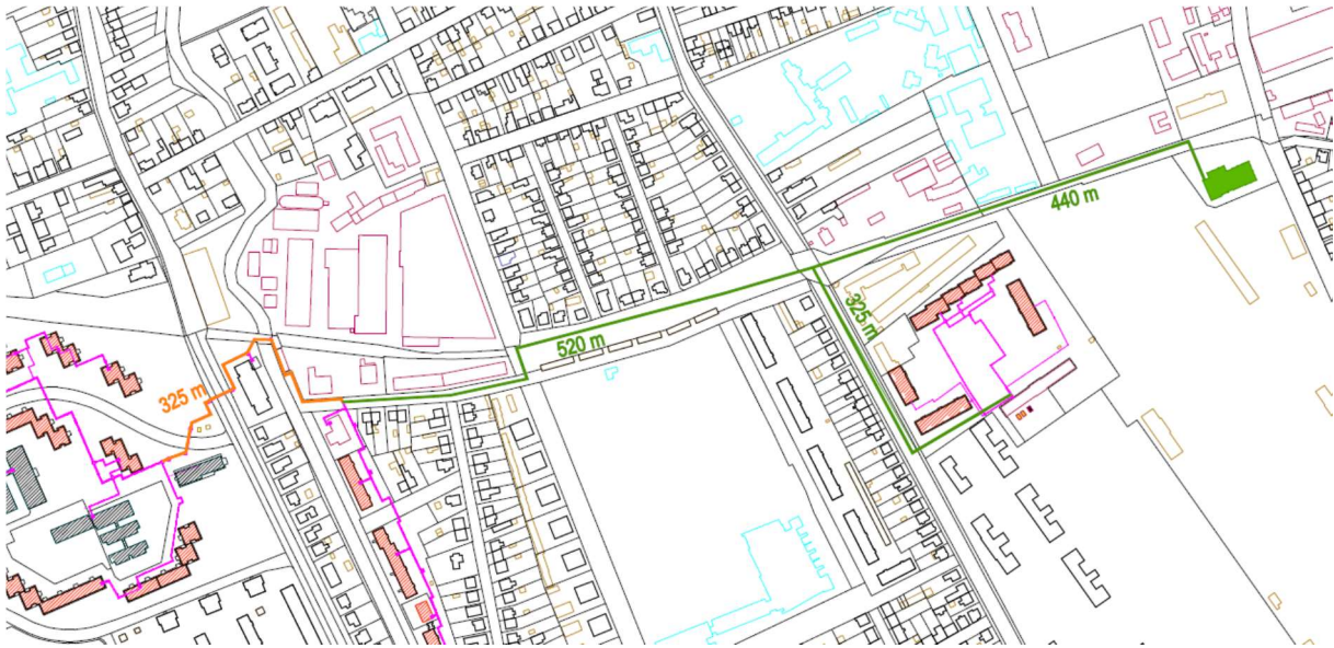
3.3.1.ábra Az északi távhőkörzetben tervezett nyomvonalak (a két változat együtt, a narancs színű a felbővítést jelöli)
