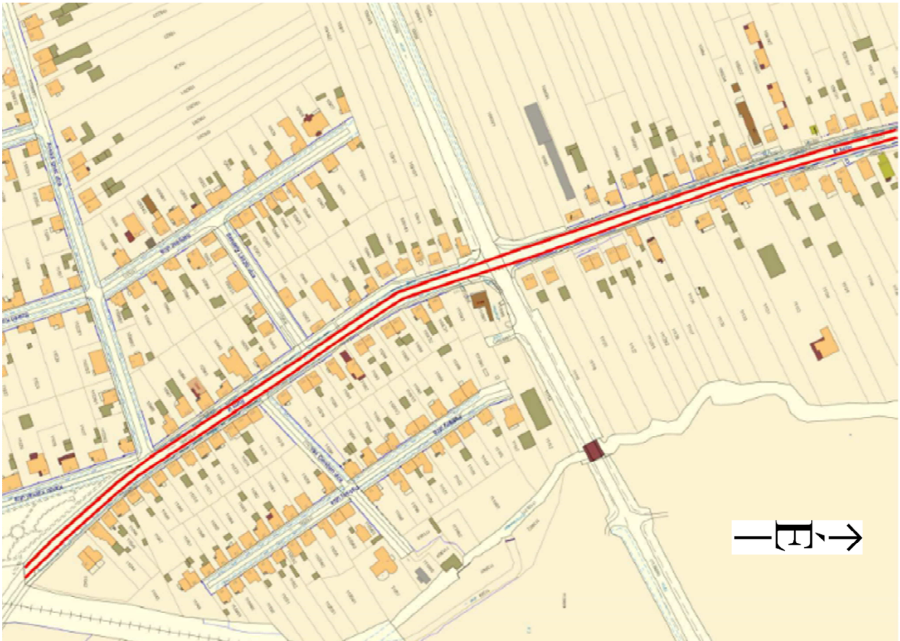
201. ábra: Kétoldali kerékpársáv kialakítása a Rumi úton, elrendezési vázlat (1. szakasz)
